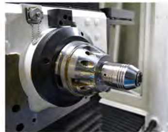
跳动小于±0.001mm的精密自动装夹套件
